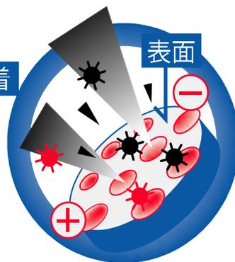
多孔質材料のため表面に無数の細孔が存在し、物理的吸着作用により臭気成分を減少させる。
